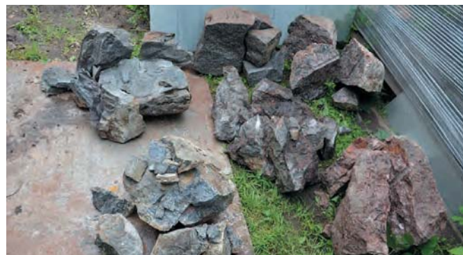
Рис. 7 Результаты электрогидравлического разрушения гранитных образцов
