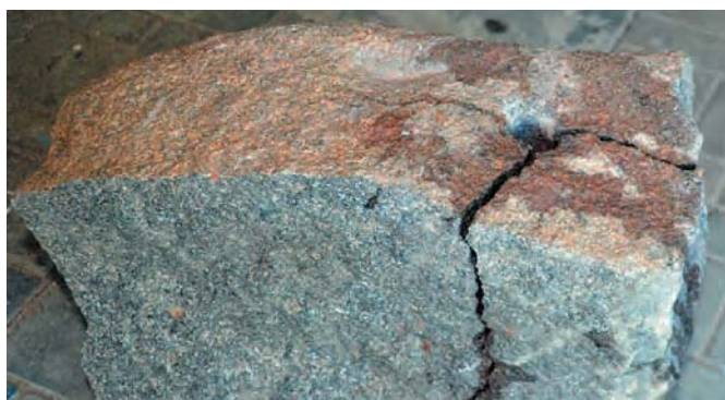
Рис. 6 Фрагмент электрогидравлического разрушения гранитного образца
