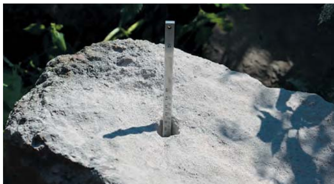
Рис. 5 Шпур для установки рабочего элемента в образце
